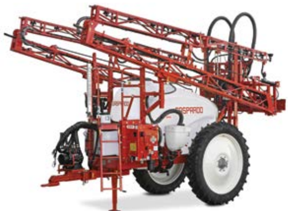
Allestimento con barra a soffietto a chiusura laterale e ultima sezione verticale. Max 21 metri.
