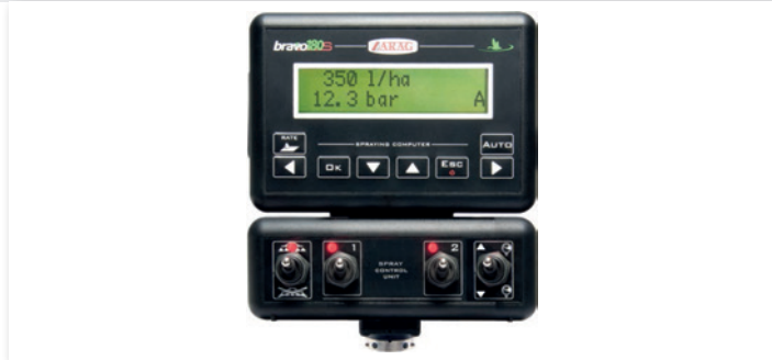
BRAVO 180 Для достижения равномерности обработки распределительный компьютер автоматически регулирует давление по мере изменения скорости. Он оснащен датчиком скорости, счетчиком литров и, в дополнение к главному/основному отключению, контролирует от 2 до 4 секций. Рабочие параметры отображаются на дисплее.
