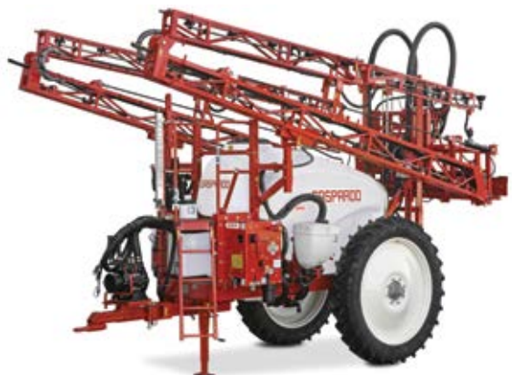
Configuration avec rampe à repliage latéral et dernière section verticale. Max 21 mètres.
