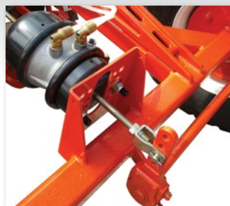
Sistem de frânare controlat pneumatic
