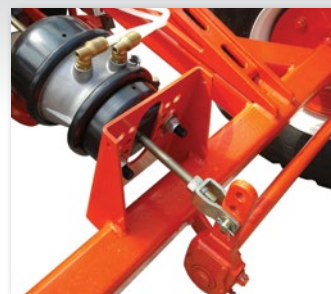
Impianto di frenatura a comando pneumatico
