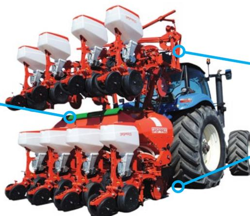
Chiusura idraulica verticale delle ali laterali
