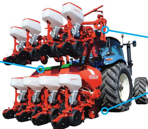
Chiusura idraulica verticale delle ali laterali
