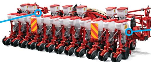
**Chiusura idraulica verticale delle ali laterali**
