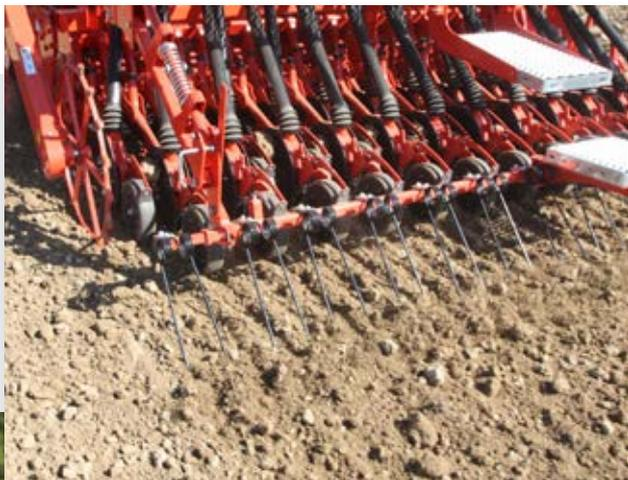
La herse de recouvrement finit ultérieurement le lit de semences. De cette façon, on augmente le contact entre graine et sol, en optimisant les conditions de germination pour une émergence rapide de la culture. Elle se prête particulièrement aux terrains irréguliers, tant en l'absence qu'en présence de résidus de culture. Il est possible de varier aussi bien la pression que l'inclinaison de la barre de recouvrement, en fonction des exigences. Le réglage peut être mécanique ou hydraulique.
