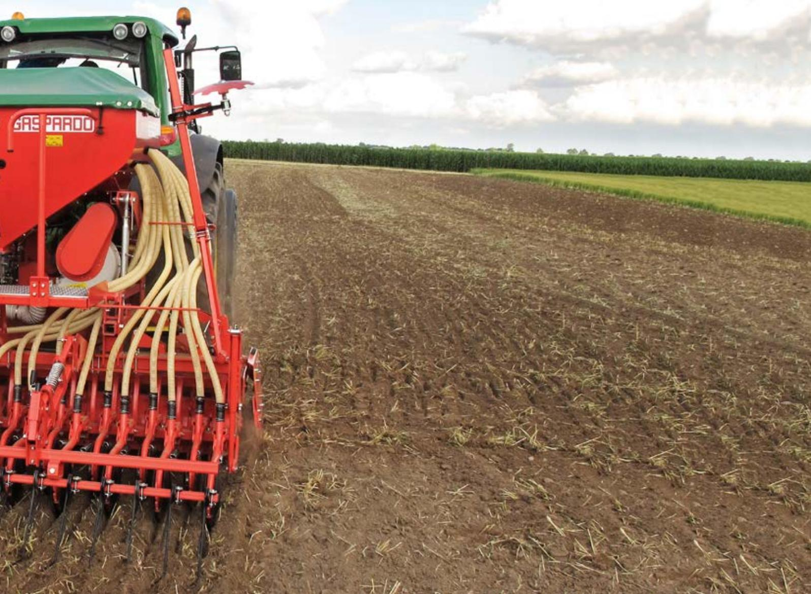
Le distributeur volumétrique permet de distribuer des graines de petites et grandes dimensions. Le transport de la graine est de type pneumatique en garantissant une distribution homogène et précise à tous les éléments, même en présence de fortes pentes. La bonne vitesse de semis et le volume de la trémie de 1000 litres garantissent une excellente capacité de semis.
